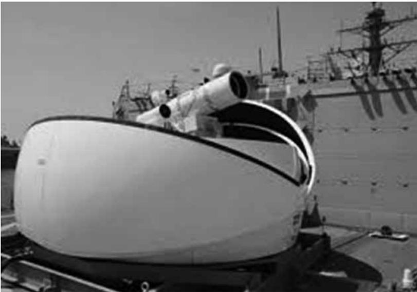
Arma de Energía Dirigida montada a bordo del transporte anfibio USS Ponce<sup>2</sup>
