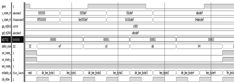
Resultado de la simulación mediante Test Bench del handshake de las CE OE y WE de la SRAM durante la lectura.
