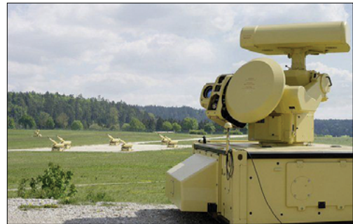
FIGURA 17: FIRE CONTROL UNIT (FCU) RADAR DE CONTROL TIRO SKYSHIELD CON SENSORES ELECTRÓPTICO INCORPORADO
