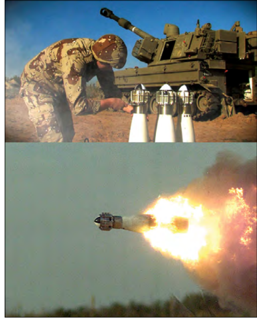
FIG. 27: CCF TOP GUN CON GUIADO GPS/INS Y CONTROL “SPIN DRAKE”
