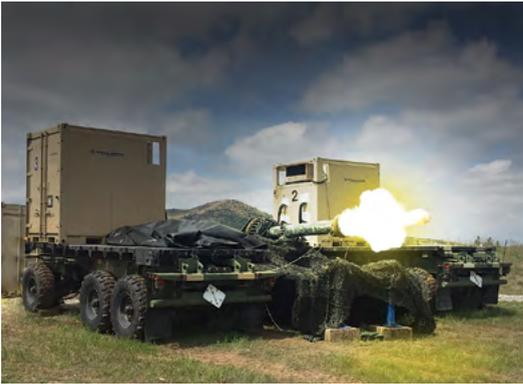
El interés del Pentágono en acelerar el desarrollo de EMRG tiene como objetivo expandir la cantidad de plataformas desde las que se pueda emplear la capacidad letal de estos sofisticados proyectiles, con alcances superiores a los 70 kilómetros. Para ello, el HVP de 127 milímetros dispondría de un "conjunto sabot" que lo guíe convenientemente dentro del ánima del tubo de 155 milímetros.
