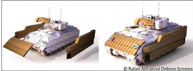
Contra un penetrador de energía cinética (APDS o APFSDS) o municiones perforantes de menor calibre (20 milímetros, 12,7 milímetros, 7,62 milímetros), los elementos dinámicos sirven para desviar la dirección de la punta.
