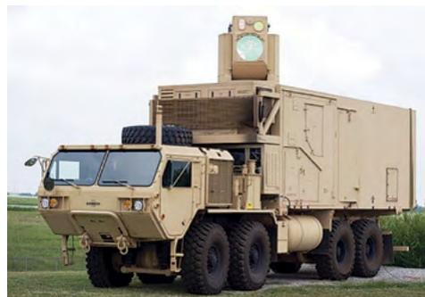
HEL MD (10kW) realizó una serie de pruebas en White Sands Missile Range, NM, probando el HEL MD, que interceptó exitosamente en más de 85 rondas de mortero, 69 fueron destruidas en vuelo.
