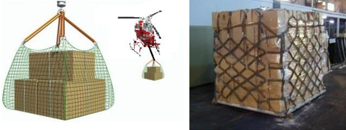
*Nota: Esta imagen muestra la red de carga y su disposición para el izado de la misma, existiendo variadas prestaciones, tamaños o formas.*
