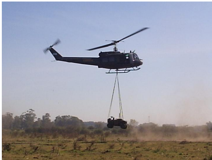
UH – 1H transportando con eslingas un vehículo Lohr
