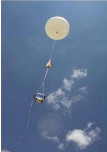
Lanzamiento de radio-sondeo meteorológico
