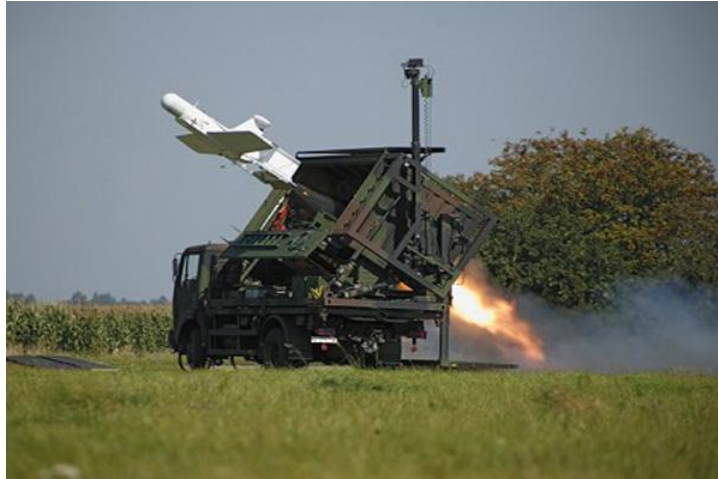
Figura 8 (Lanzamiento del pequeños aviones para la adquisición de blanco) (Fuente: Ejército / Heer)
