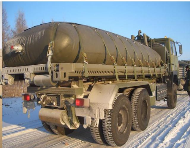
Tanque plegable sobre plataforma VEMPAR o auto-descargable roll-off.
