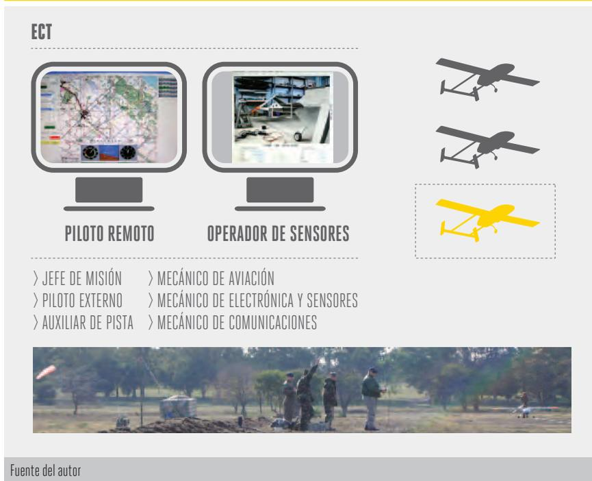
*Aircraft Vehicle*) obtiene la imagen del objetivo en vuelo con múltiples sensores que pueden ser cámaras fotográficas, radares de apertura sintética o filmaciones en video y vía data link transmite la información a una Estación de Control Terrestre (ECT) en tiempo real o casi real. Puede operar en extensos rangos operativos para obtener información: *Line of Sight* (LOS) o *Beyond Line of Sight* (BLOS) con ayuda satelital (figura 1).
