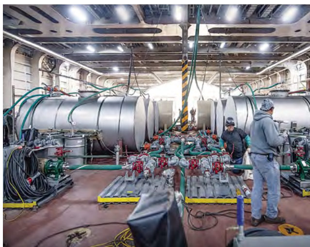
Proceso de hidrólisis desarrollado dentro del buque.
