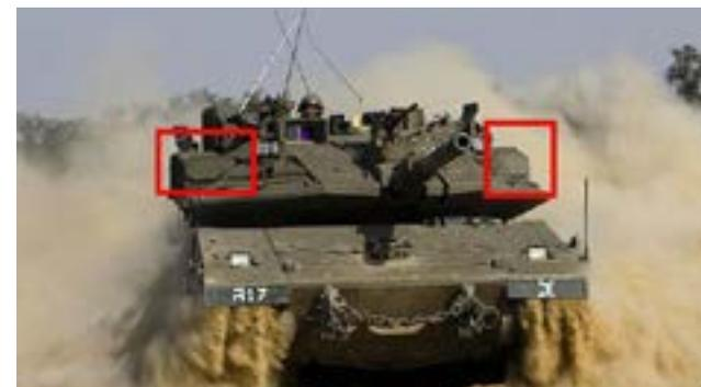
*Figura 5. Tanque “Merkava Mk IV”. Es el modelo conocido más avanzado. Nótese en los recuadros los lanzadores del sistema “Trophy”.*
