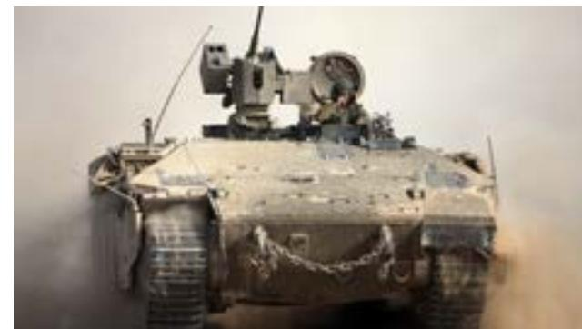
*Figura 4. Vehículo de combate de infantería “Namer”. Su armamento principal es una Amet 12,7 mm, montada en una torreta de comando remoto.*
