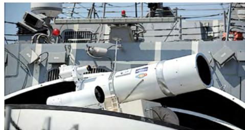
LAWs instalado en el USS Dewey - US NAVY - o el USS PONCE (30kW)
