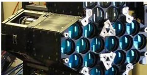
EXCALIBUR de DARPA emplea con éxito una matriz óptica de 21 elementos. Impulsado por amplificadores de fibra láser, alcanzó con precisión un objetivo a 7 kilómetros.
