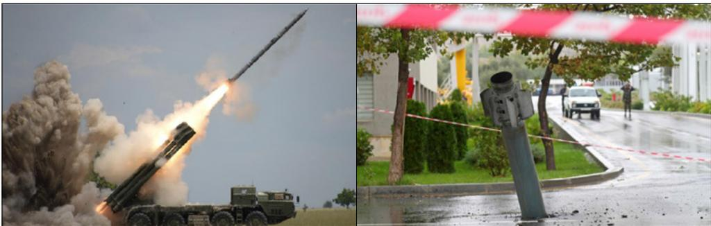
El BM-30 "Smerch" emplea diferentes tipos de cabezas de guerra para sus cohetes de 300 milímetros de calibre y 7,5 metros de longitud. El cohete 9M528 usa una carga unitaria de alto explosivo de 240 kilogramos y tiene un alcance de 90 kilómetros. También dispone del cohete 9M55K
