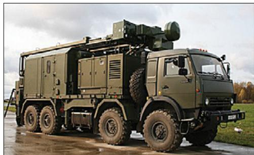
Provee Inteligencia de señales y ancho de banda de frecuencia de supresión electrónica entre los 200 a los 6000 MHz.
