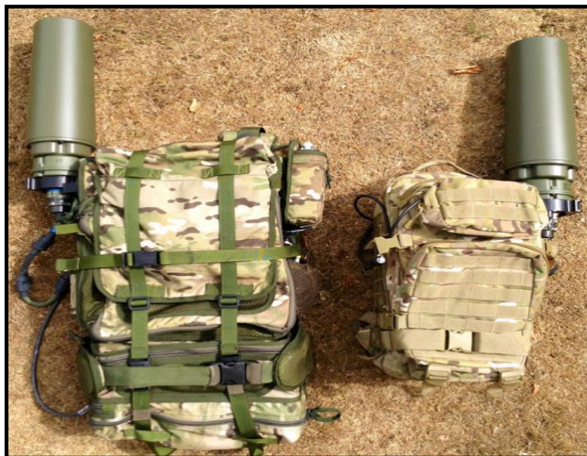
Figura 10. Sistema mochilar de GE. Portátil. Versión ligera, diseñada para misiones que impliquen ejecutar GE durante una marcha.
