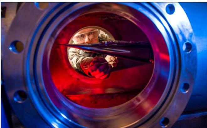
UN TÉCNICO DE LA USAF UTILIZA UN TÚNEL DE VIENTO DE TUBO LUDWIG PARA MEDIR LAS PRESIONES, TEMPERATURAS Y CAMPOS DE FLUJO DE VEHÍCULOS DE INVESTIGACIÓN HIPERSÓNICOS Y GEOMÉTRICOS BÁSICOS.
