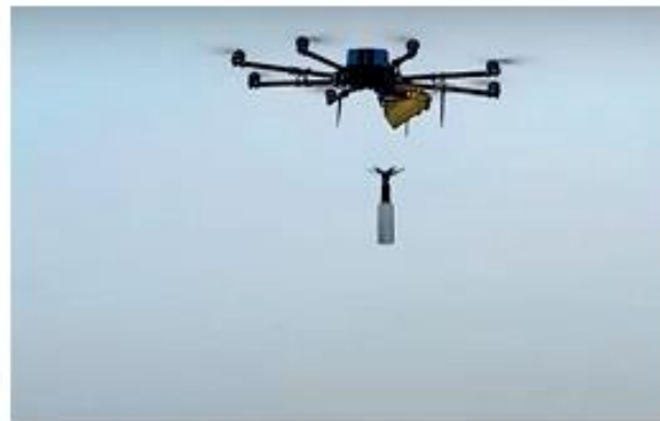
Fig. 37. Octocóptero R18 fabricado por Aerorozvidka, transportando dos granadas antitanques RKG-3 y RKG-1600 de origen soviético. (Foto: www.dronedj.com )
