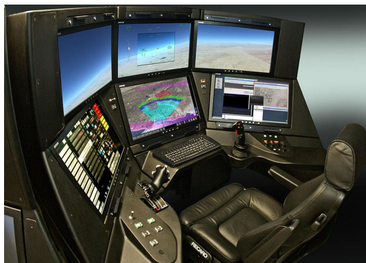
Fig. 80. Cockpit Avanzado de la Estación de Control Terrestre (ECT)
