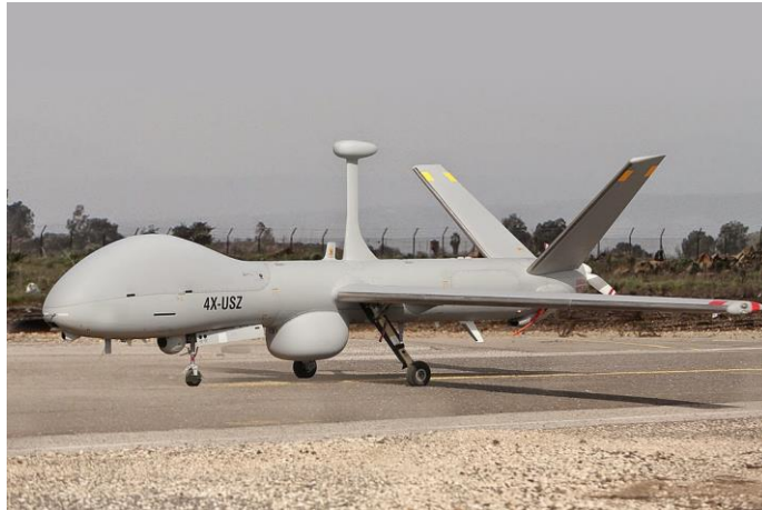
Fig. 46. Elbit System Hermes 900 de patrulla marítima con radar Galileo T-200 133
