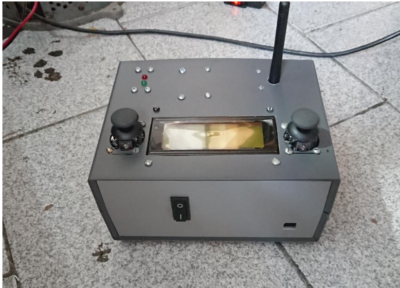
Figura 6: Consola de comandos con visor en LCD 20x4 líneas
