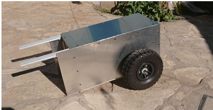
Figura 2: Estructura de aluminio del robot
