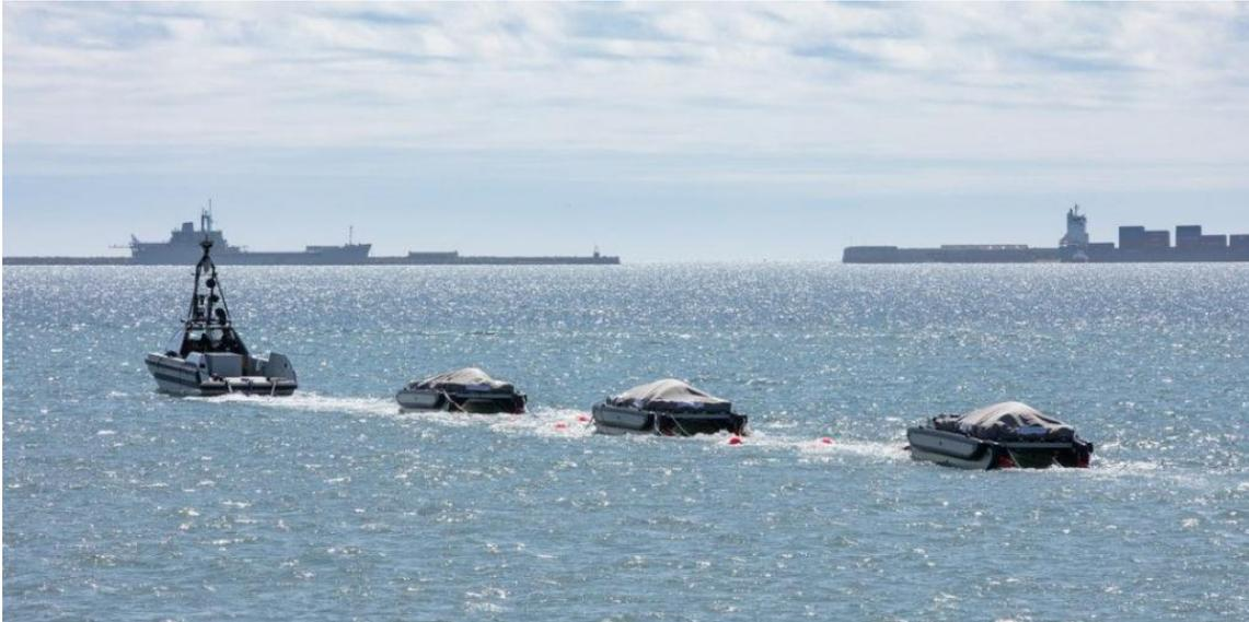
Figura 7: USV ARCIMS remolcando un arreglo de desminado
