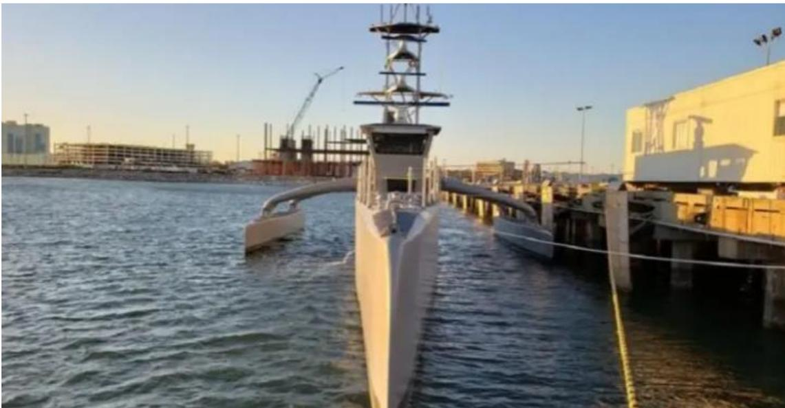
Figura 2: Prototipo vehículo de superficie no tripulado mediano (MUSV) – *Sea Hawks*
