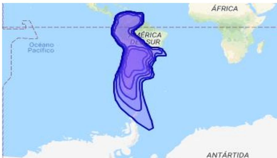
**Figura 4. Área de cobertura de la Banda KU del satélite ARSAT-2 (AR-SAT, 2023).**
