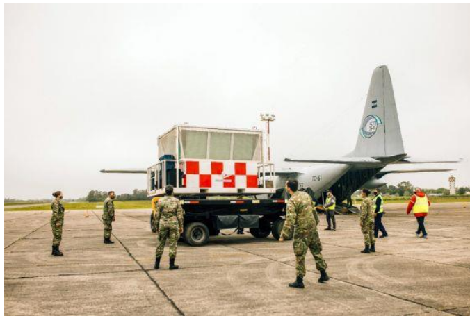
Figura 3 Torre de control de vuelo móvil de la Fuerza Aérea Argentina puesta al servicio del Aeropuerto de Mar del Plata durante tareas de refacción en noviembre de 2021 fuente: https://www.eana.com.ar/novedades-del-sector/llego-mar-del-plata-la-torre-de-control-movil-que-operara-en-el-aeropuerto
