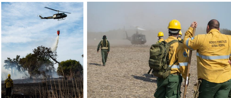
Figura 2. Sistema helibalde operando en incendios en la provincia de Santa Fe año 2020 fuente: Personal que participo de dicha actividad
