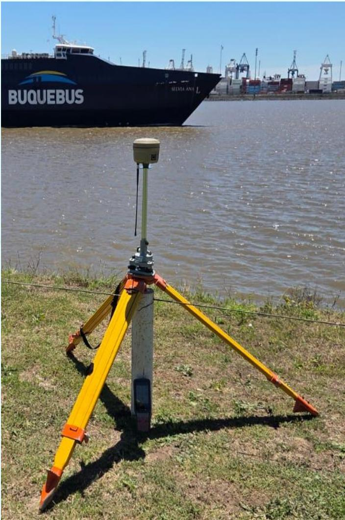
Se instaló en cada punto, una controladora GNSS con su base nivelante para la recolección de datos, previamente configurando los parámetros necesarios para la adquisición correspondiente. Se ha empleado como marco de referencia horizontal y vertical WGS84. El equipo mantuvo una lectura continua de 1h45m en cada punto. Luego, se descargaron los archivos RINEX de la página web del IGN para realizar la corrección diferencial en post-proceso y así obtener coordenadas para ambos puntos.
