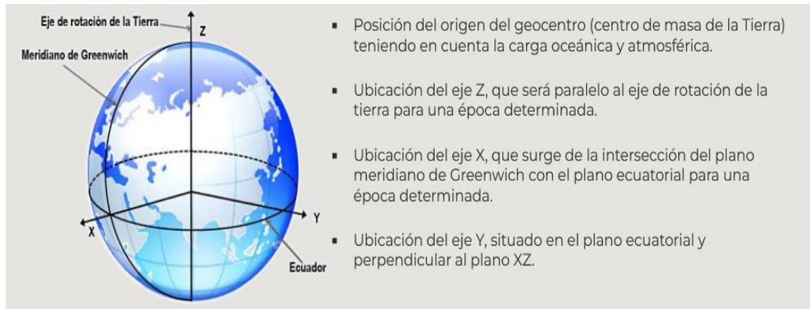
Figura 3.2.1 Sistema de referencia geocéntrico WGS 84
