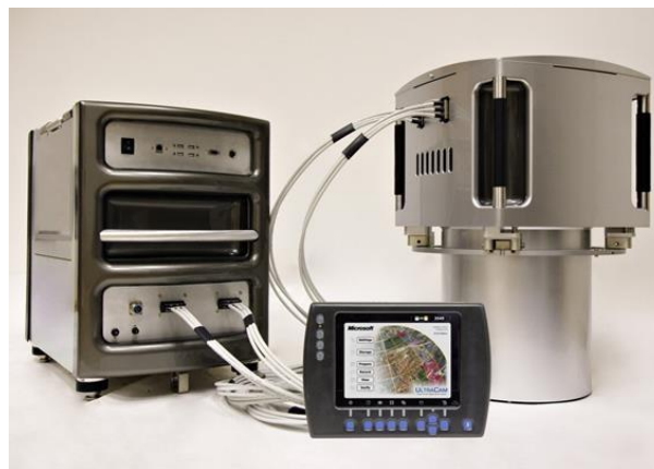
Figura 4.6.1. Cámara fotogramétrica aérea Sensor Vexcel UltraCam Xp.
