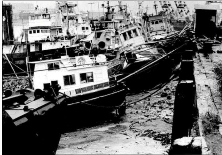
Figura 7. Gran bajante del Río de la Plata provocada por una onda de tormenta negativa el 29 de mayo de 1984 en la Vuelta de Rocha.
