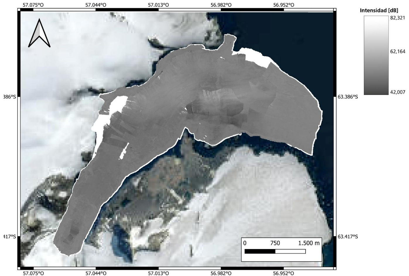
Mapa 4: Superficie de retrodispersión final mediante el procesamiento del área de estudio, utilizando el algoritmo WMA.
