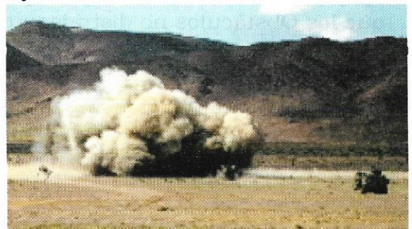
BRECHA ABIERTA MEDIANTE SISTEMA MICLIC
