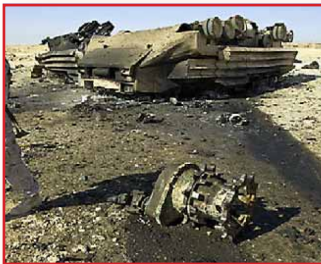
El AAV perdido en Haditha pasó sobre o cerca de un IED que, al explotar, lo levantó por el aire, incendió y aterrizó sobre su parte superior, arrojando pesadas partes a gran distancia, como el conjunto de la rueda tractora que se ve a la derecha de la foto. Photos by Jacob Silberberg / Associated Press
