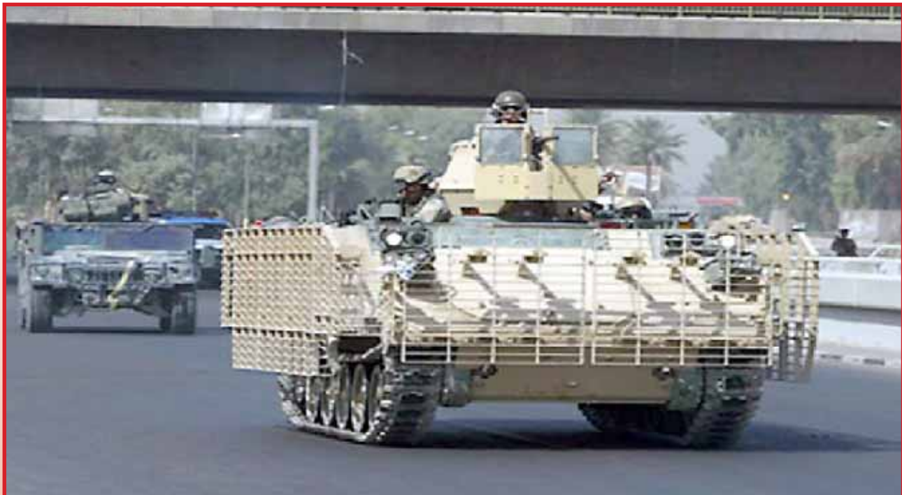
M113 del US Army tipo Super Gavin, durante una patrulla en Irak, mostrando la rejilla anti RPG.
