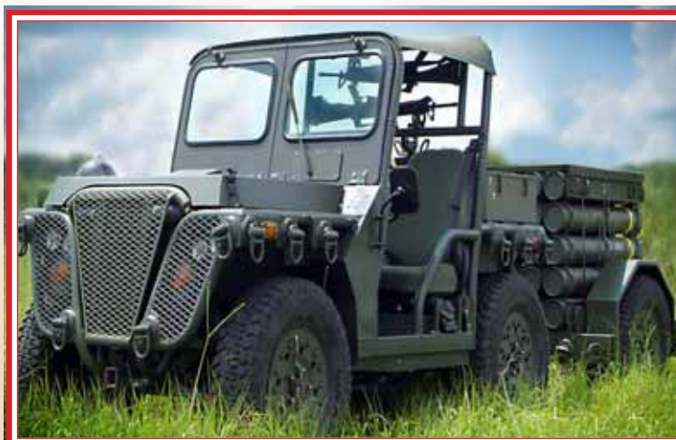
ITV – EFSS PM (Internally Transportable Vehicle – EFSS Prime Mover) transportando munición para el mortero de 120mm.
