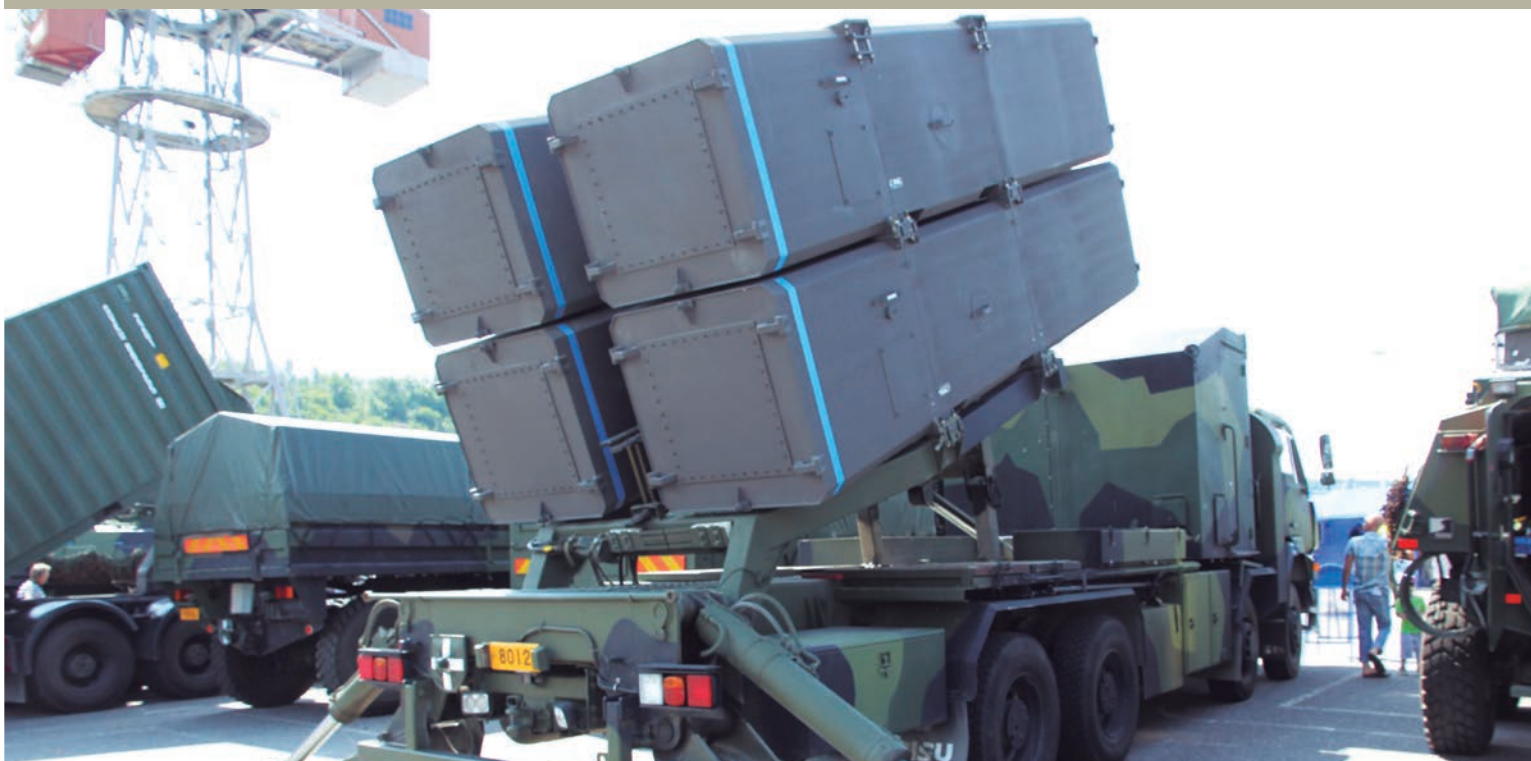
► Camión Sisu SK242 usado con Bofors RBS-15 Mk III misil antibuque 85M.
