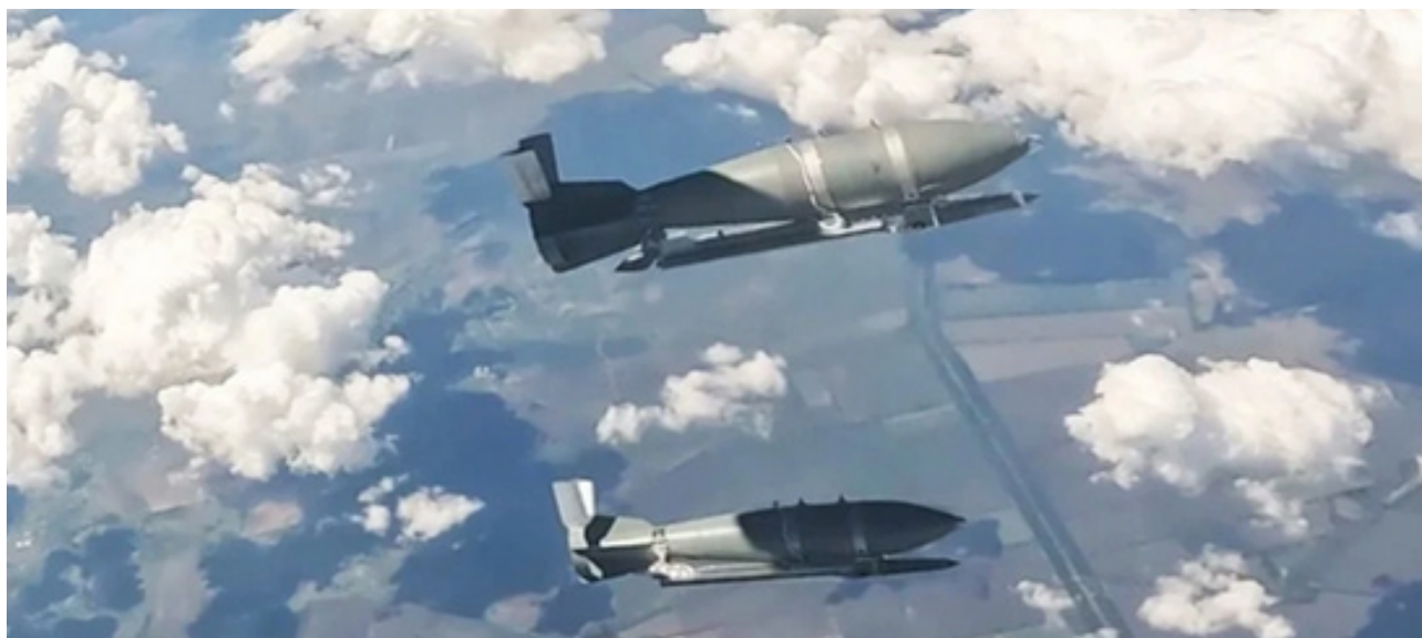
Imagen N.º 5. Bombas aéreas guiadas FAB-3000 equipadas con un kit de guía UMPK.
