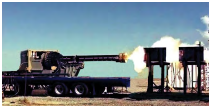
FIGURA 10: GENERAL ATOMICS (GA) - PROTOTIPO DE RAILGUN
