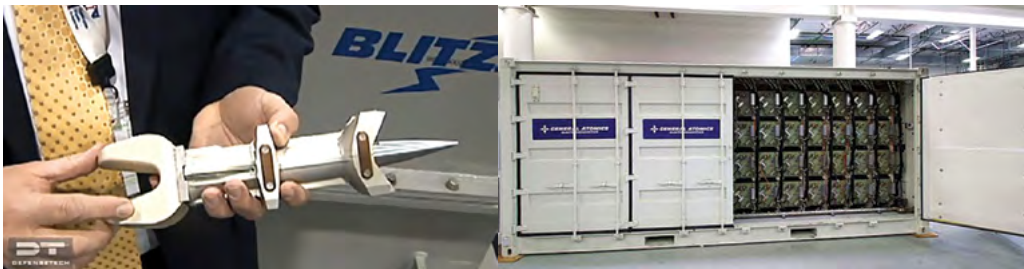
FIGURA 19: GENERAL ATOMICS. PROYECTIL "BLITZER" Y PULSE POWER CONTAINER
