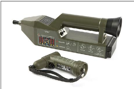
Detector químico AP2C portátil, para control de contaminación por agentes G (GA, GB, GD, GF), VX y HD en forma de vapor o aerosoles. Adecuado para uso militar (encendido rápido, medida inmediata, operación con una sola mano, simplicidad de uso, capacidad para apagarse sin precauciones).
