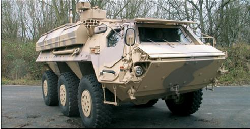
Sistema de reconocimiento NBC blindado Fuchs / Fox, equipado con detectores de última generación incorporados, el sistema puede determinar rápidamente la presencia de contaminación NBC en el suelo y en el aire, cubriendo grandes áreas.
