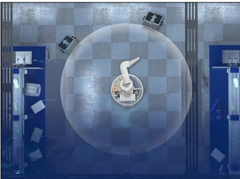
El proceso automatizado llena la habitación con vapor de peróxido de hidrógeno al 35% de Bioquell.
