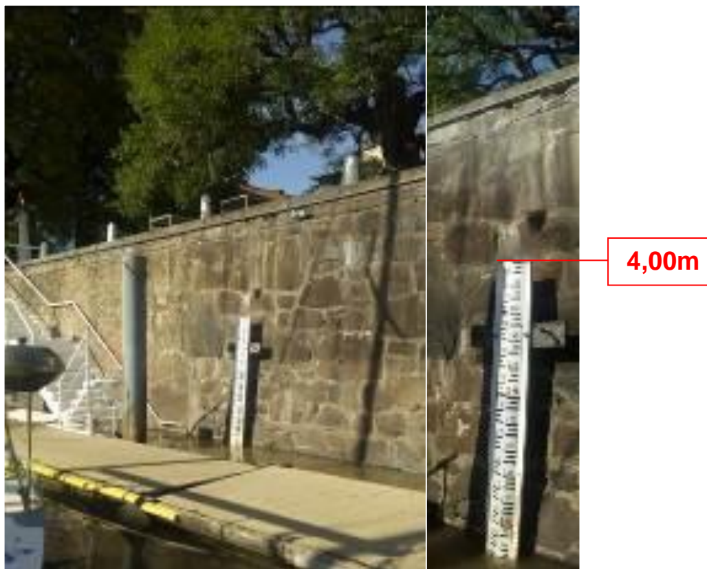
Figura 7.2.2 – Ubicación de la regla YCA2 en el espigón del YCA
