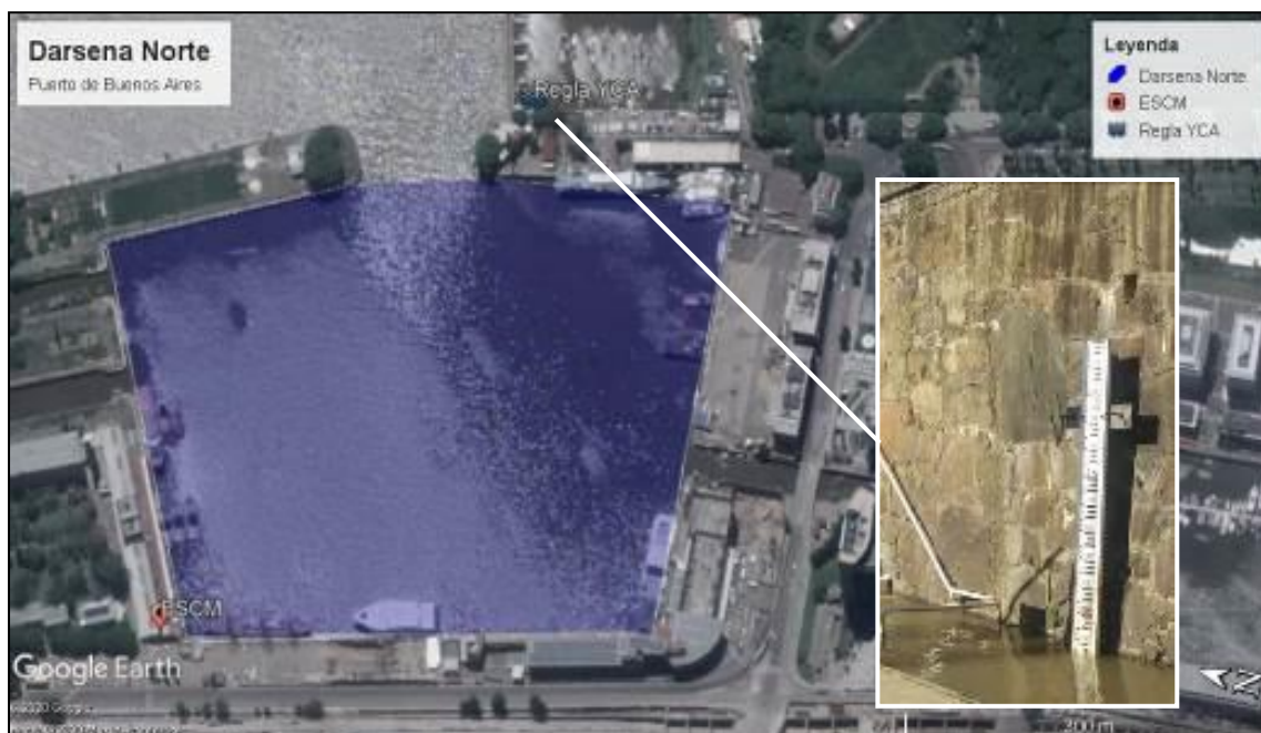
Figura 7.2.1 – Dársena Norte y ubicación de la regla hidrométrica en el YCA
