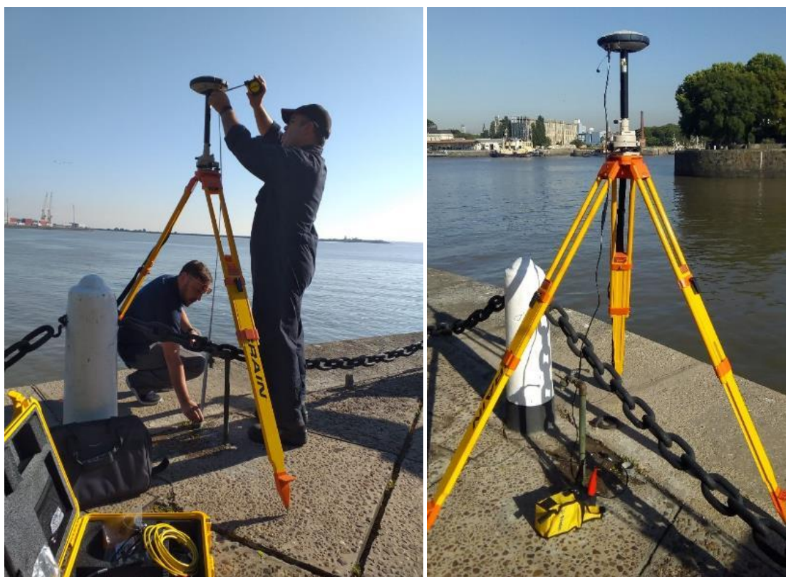
Figura 7.3.2 – Equipo GNSS Base Spectra Precision SP60 con radio interna UHF
