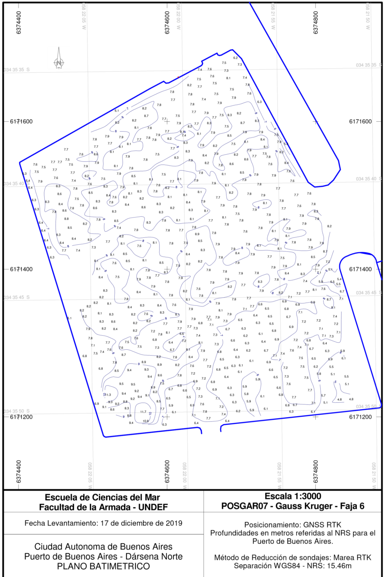
Figura 7.4.6 – Plano batimétrico por marea RTK (software TMC)
