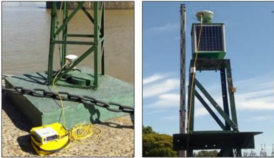
Figura 7.2.7 – Baliza verde, ocupación con GNSS en la base (figura izquierda) y sobre la lámpara de tope (figura derecha)
