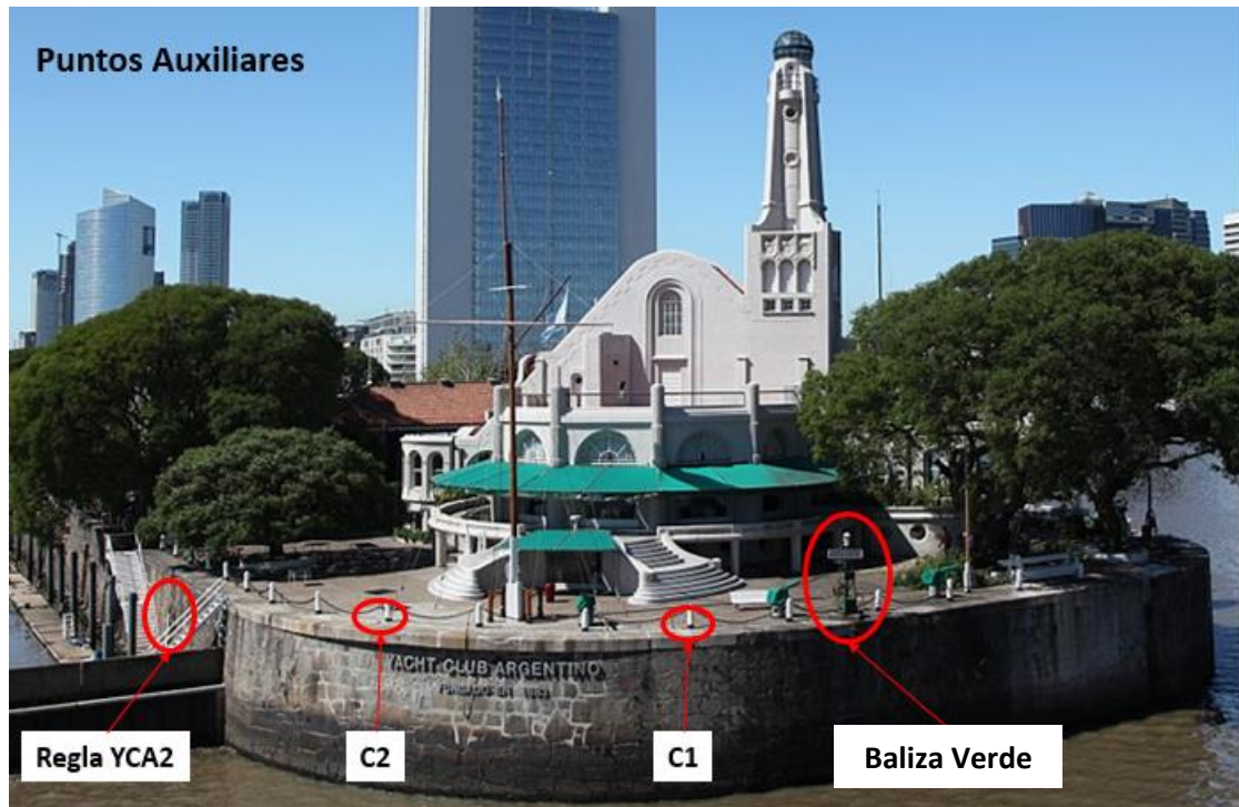
Figura 7.2.3 – Vista de los puntos auxiliares utilizados para trasladar el NRS referido a la regla YCA2
