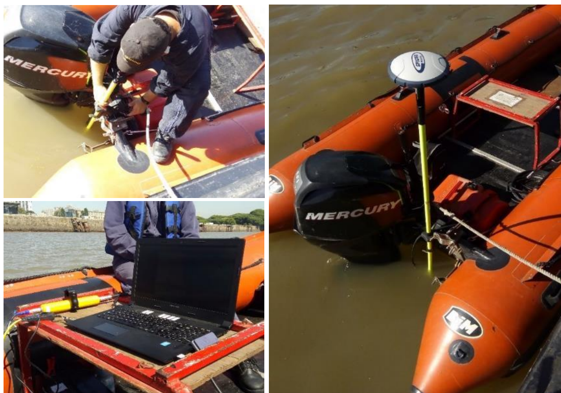
Figura 7.3.3 – Montaje del equipo GNSS móvil con ecosonda y laptop con el software HYDRopro
