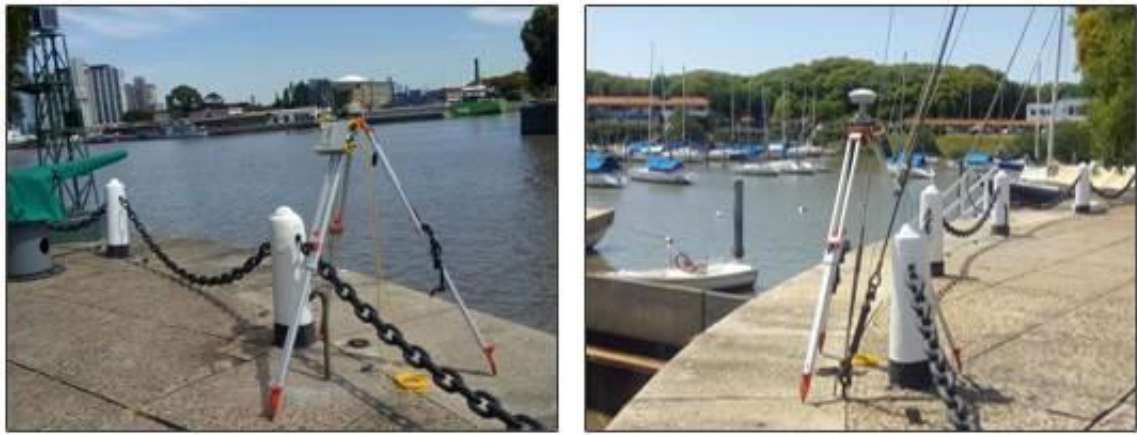
Figura 7.2.6 – Ocupación GNSS con receptor Trimble MPS865 – C1 (izq.) y C2 (der.)
