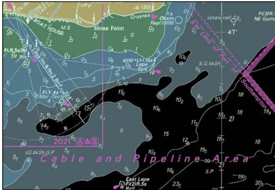
Figura 2.3.3 - Visión de un RNC de noche. Fuente: OHI (2017).
