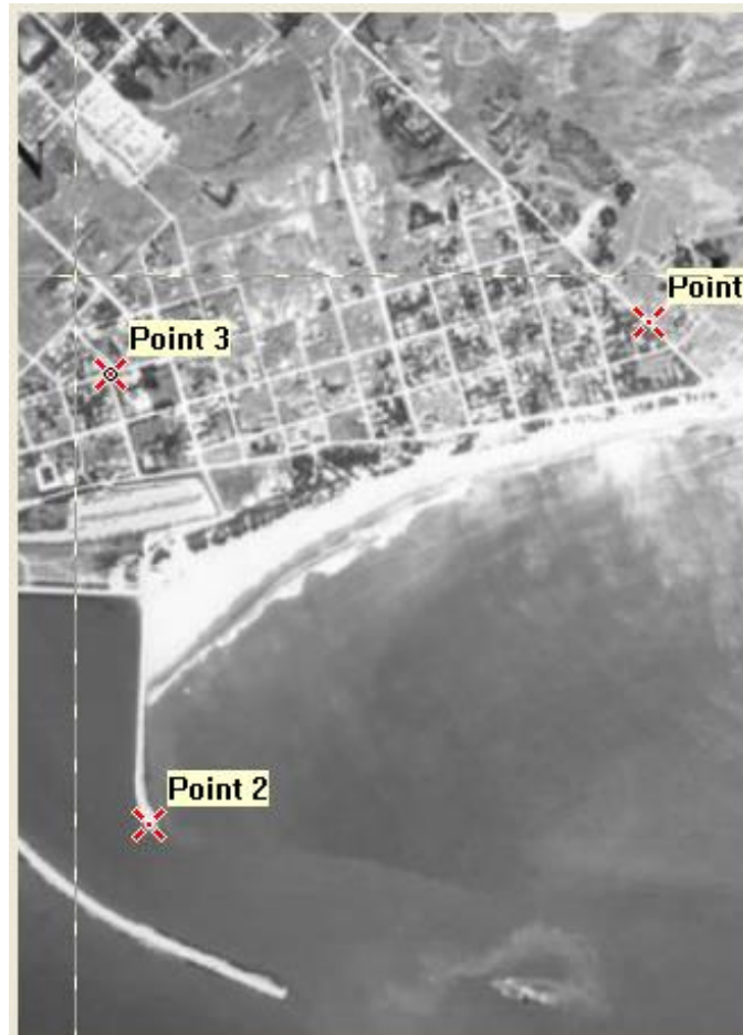
Figura 55: Georreferenciación de la fotografía aérea (A) por puntos de campo obtenidos en la campaña.
