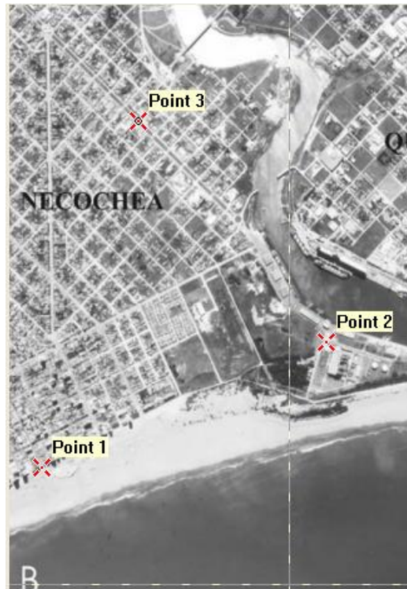
Figura 56: Georreferenciación de la fotografía aérea (B) por puntos de campo obtenidos en la campaña.
