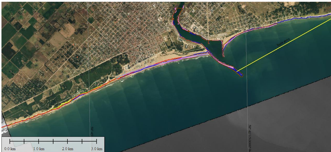
Figura 63: Vista de todas líneas de costas digitalizadas y líneas de base, ya transformadas al mismo sistema referencia horizontal y proyección.
