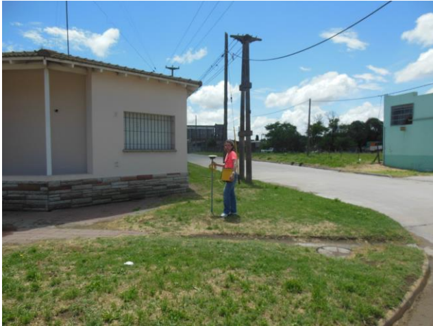
Figura 46: Campaña geodésica. Captura coordenadas de esquinas significativas para la georreferenciación de imágenes. Punto tomado en la esquina de (Fuente: registro propio).
