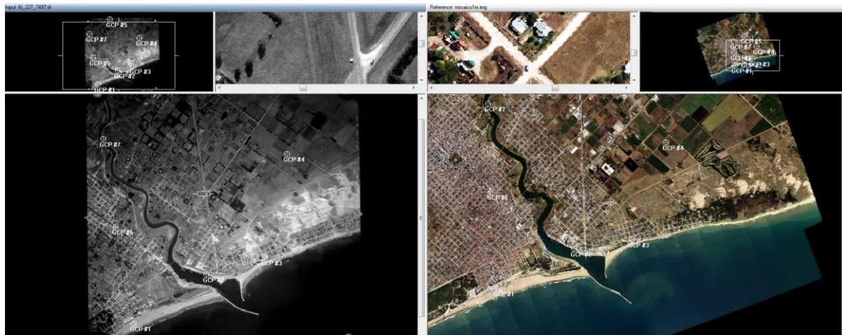
Figura 57: Georreferenciación imagen a imagen, a través del programa ERDAS.
