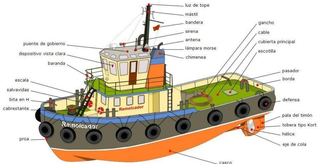
Figura 1 Remolcador básico para puertos.
