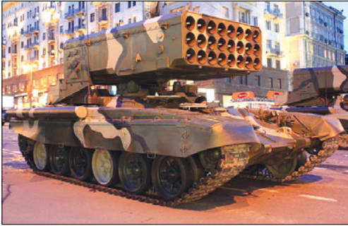
FIGURA 13: MLRS TOS-1 "BURATINO" CALIBRE 220 MILÍMETROS
