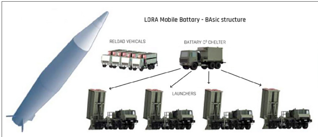
FIGURA 17: ESQUEMA DE UNA BATERÍA DE SRBM LORA
