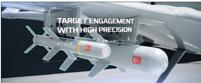
FIGURA 24: MISILES GUIADOS POR LÁSER SEMIACTIVO MAM-C Y MAM-L
