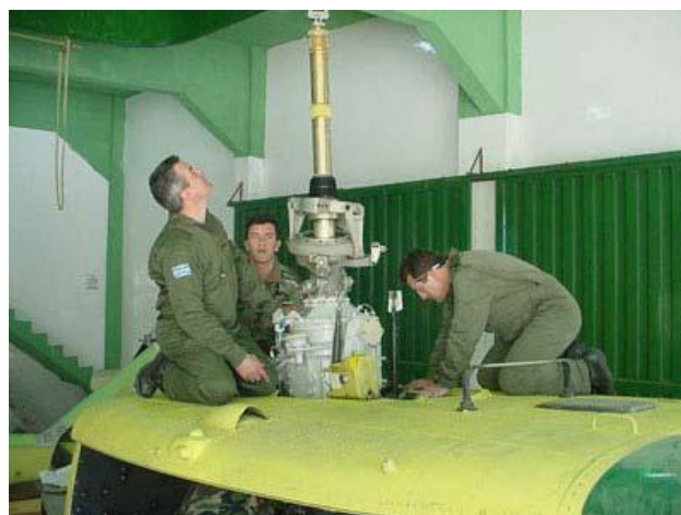
Foto 5 – Instalación de la transmisión
