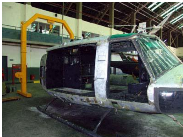
Foto 2 – Decapado para control de fisuras y corrosión
