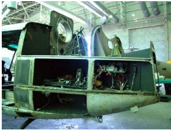
Foto 3 – Despiezado para el reemplazo estructural
