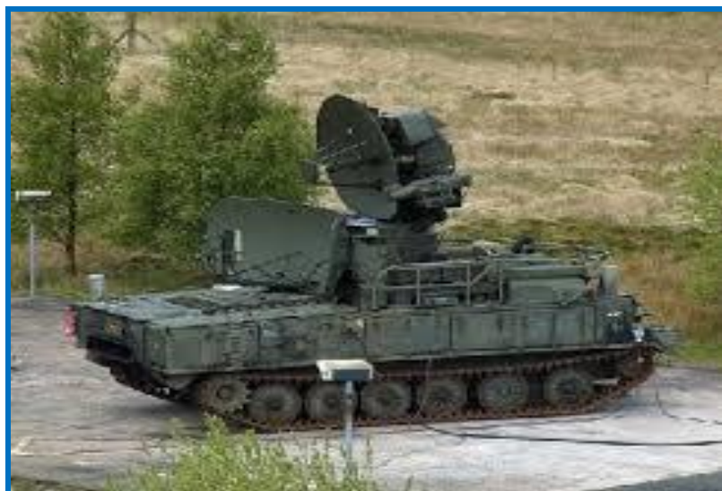
Fotografía Nro 8 – Sistema de radar para Misil antiaéreo tierra-aire SAM
