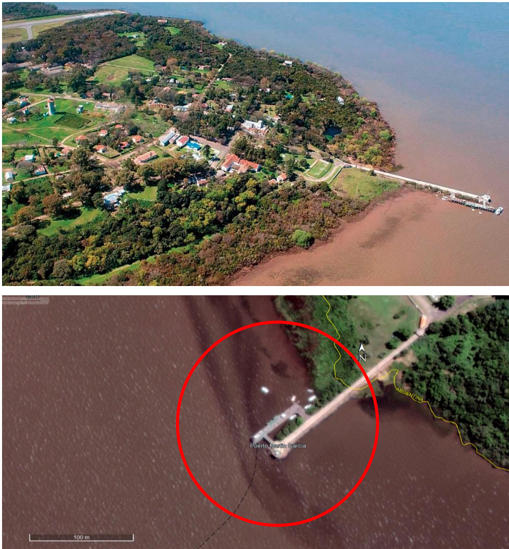
Fig. 7 y 8: La constante sedimentación sobre el muelle de la Isla Martín García, resulta una complicación para aquellas naves que desean amarrar. El muelle también actúa como barrera para la retención de los sedimentos.
