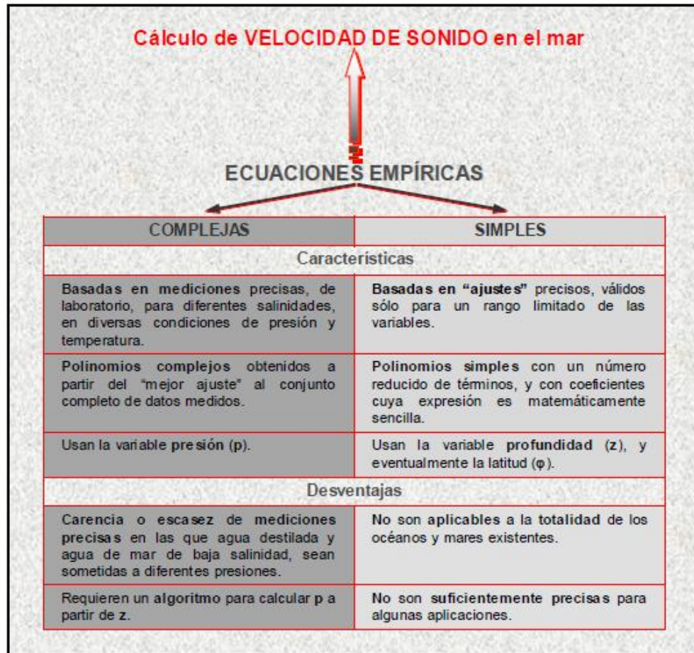
FIGURA 1.2 Resumen esquemático del Cálculo de Velocidad del Sonido en el mar a partir de Ecuaciones Empíricas [cuadro extraído de Blanc et al. , 2010].
