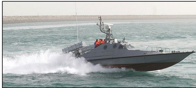
Figura 2-32. FAC clase Peykaap , armada con ASCMs y torpedos. Fuente: https://navalpost.com/understanding-irans-naval-forces-irin-irgc/
