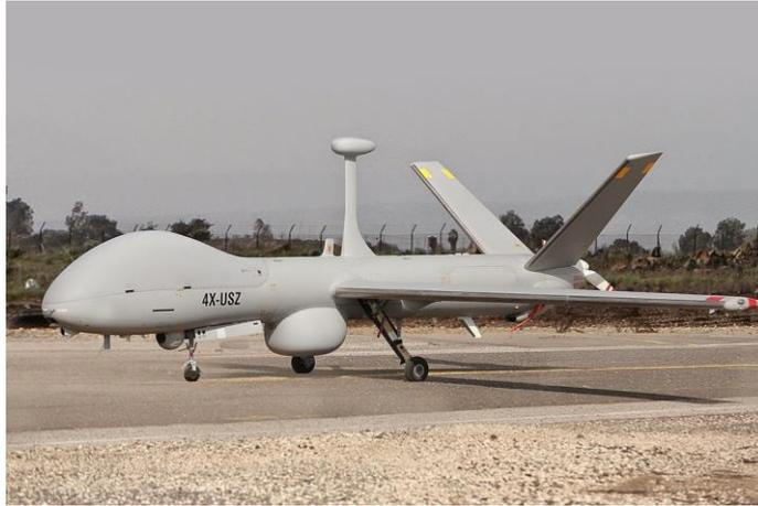
Fig. 53. Elbit System Hermes 900 de patrulla marítima con radar Galileo T-200<sup>99</sup>
