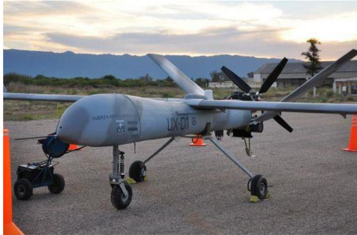
Fig. 24. Prototipo del VANT Clase I, Aucan.
