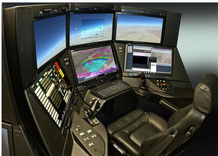
Fig. 38. Cockpit Avanzado de la Estación de Control Terrestre (ECT)
