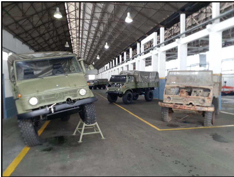
Figura 20. Imagen de la planta de repotenciación del Unimog 416, a la izquierda vehículo repotenciado, a la derecha vehículo a reparar en las instalaciones del Batallón de Arsenales 601.
