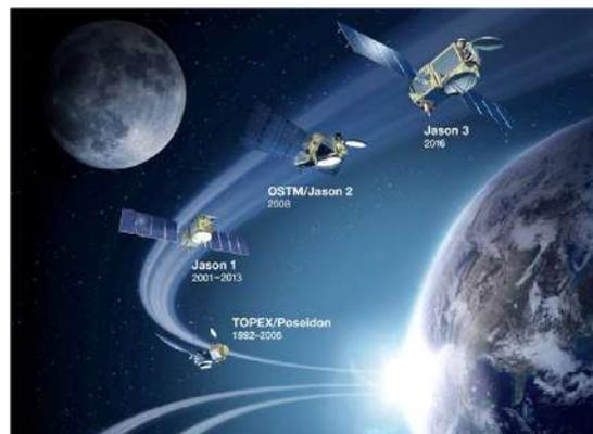
Satélites altimétricos TOPEX/POSEIDON, JASON 1, 2 y 3 utilizados para la medición del nivel del mar.
