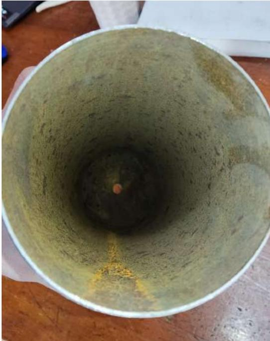
Recipiente condenado por corrosión en paredes internas – Taller de Armas BNPB.
