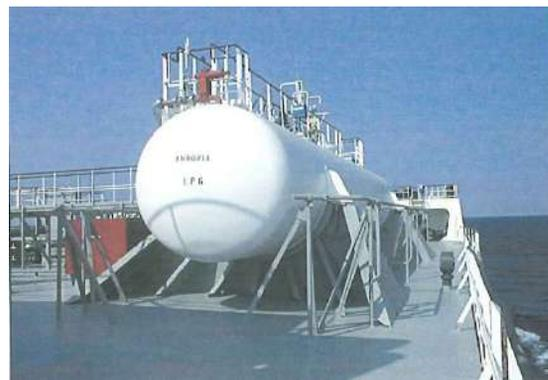
Recipiente en la cubierta superior de un buque tanque.
