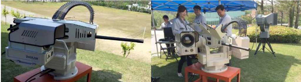
FIGURA 28: D00DAAM SUPER AEGIS II (COREA SUR), TIENE UN ALCANCE DE 4.000M Y UNA PODEROSA AMETRALLADORA CAPAZ DE NEUTRALIZAR VEHÍCULOS LIVIANOS
