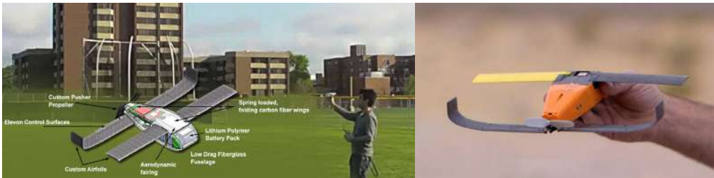
FIGURA 23: PROYECTO PERDIX DESARROLLADO POR EL MIT LINCOLN LABORATORY EN 2013. MINI-DRONES CAPACES DE OPERAR EN ENJAMBRES. SU COMPORTAMIENTO SE BASA EN LA SINCRONIZACIÓN ENTRE TODOS LOS INDIVIDUOS Y LA CAPACIDAD DE APRENDIZAJE DEL CONJUNTO.
