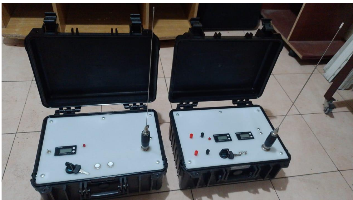
Imagen 1: explosor inalámbrico, integrado por 2 módulos (uno emisor y otro receptor)
