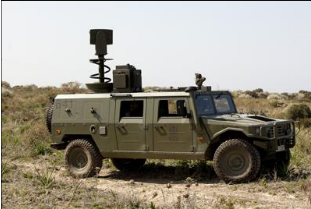
Figura 1. Sistema de Exploración y Reconocimiento Terrestre (SERT), montado sobre vehículo Hummer.
