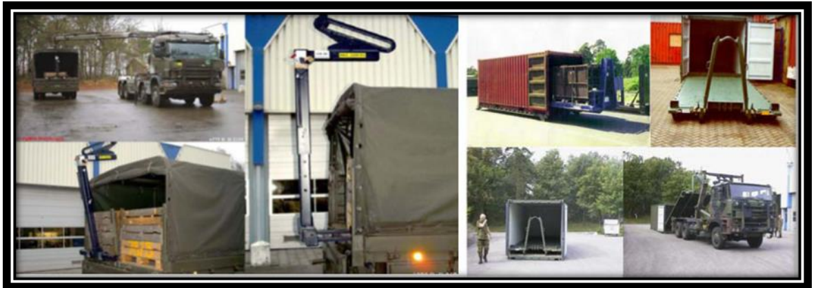
Figura 21: Foto de los sistemas para carga y descarga de pallets de contenedores, y de la plataforma rodante de carga y descarga de contenedores.
