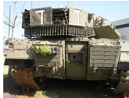
VC Tan MERKAVA LIC (obsérvense las rejillas en los escapes, la ventana para el tirador y las cadenas anticohetes)
